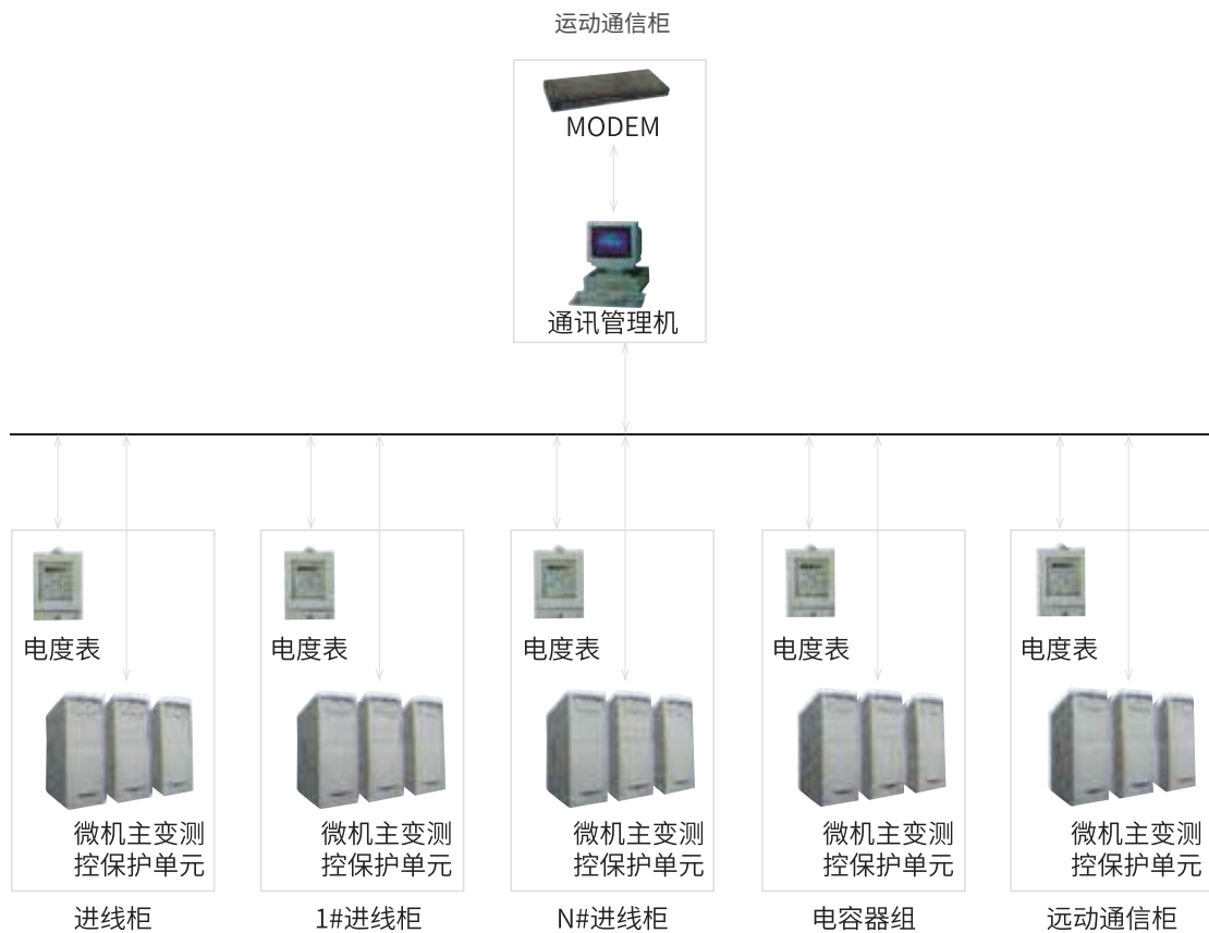
40.5kV 无人值班式站系统配置图
